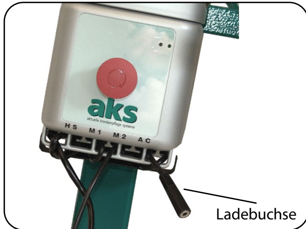
Abb. 8.7.05 – Steuereinheit mit Ladebuchse
